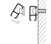
**IT** Posizionare il binario sulla parte superiore della rondella (clip) e fare clic per metterlo in posizione finale.
