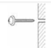
**IT** Montare le rondelle (clip) dei binari con viti e tasselli (Ø 6 mm) nel muro in linea retta ad intervalli di ± 30 cm.
